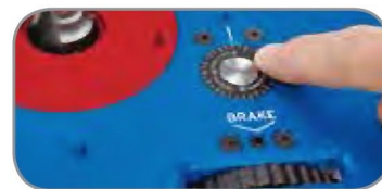
Колесо микроподстройки делает ненужным ключ
